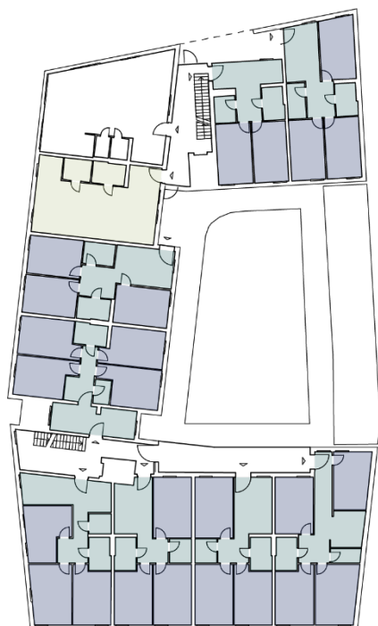
Abbildung 161 Grundriss Erdgeschoss, Kassel, M 1:500. [© DGJ Architektur GmbH]
