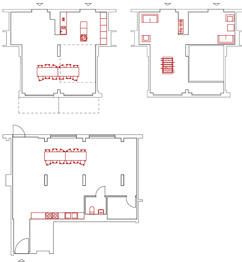
Abbildung 73 Grundriss Berlin-Marzahn, Gemeinschaftsräume in RG (oben) sowie Gemeinschaftsraum im EG (unten), M 1:200. [© DGJ Architektur GmbH]
